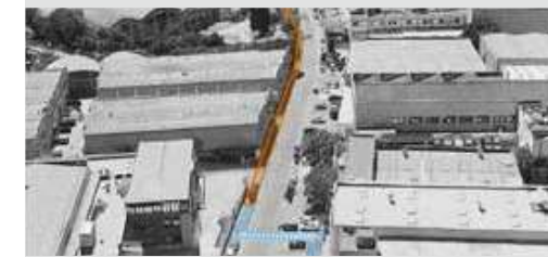
Millora la mobilitat dels vianants. Posar pilones, assenyalar pas de vianants a tot el carrer, eventualment millorar l'il·luminació i visibilitat. Aquesta transformació pot ser l'inici d'altres per fer segurs els camins quotidians a grans empreses, equipaments i serveis. Ubicació: c/ Torrent de l'Estadella
